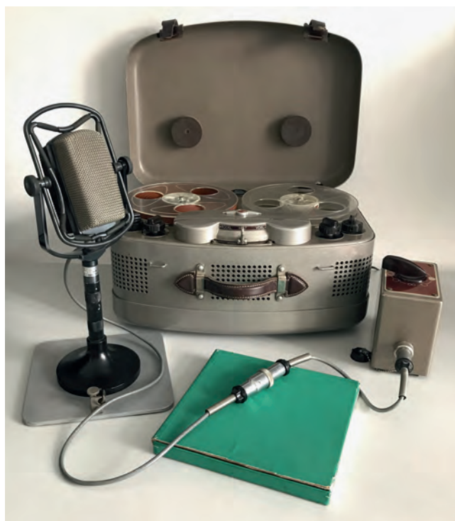
123. a) Tonband- gerät Philips Super Maestro mit einem AKG-D45 Mikrofon mit der Serien- Nummer 1, aus dem historischen Bestand des Pho- nogrammarchivs b) Tonbandgerät Stuzzi Magnette, aus dem histori- schen Bestand des Phonogramm- archivs
